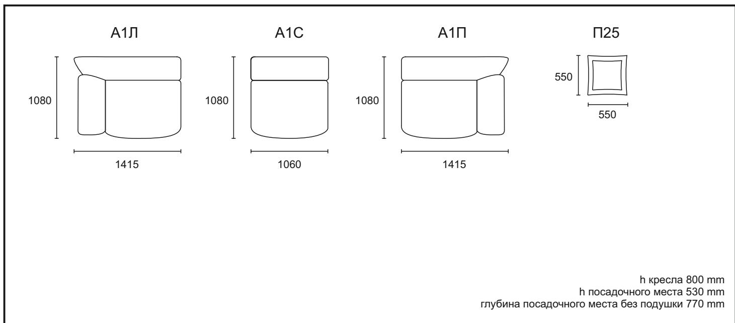
Согласно ГОСТ 19917-2014: для мебели, габаритные размеры которой определяются размерами мягкого элемента, предельные отклонения от габаритных размеров не должны превышать +/- 20мм.
